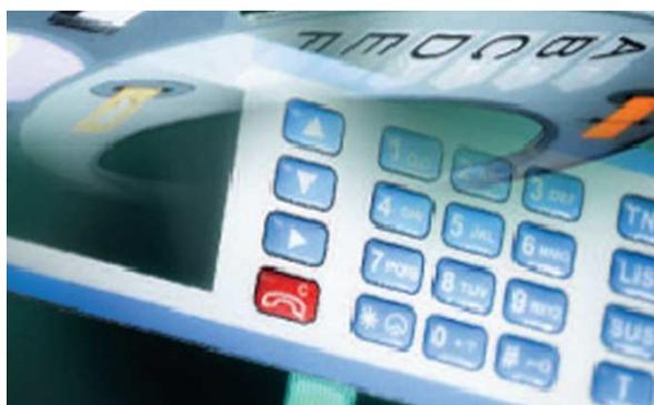
Para los teclados de membrana, las tintas de curado UV se han convertido en una importante alternativa a las de base solvente. Por sus incomparables ventajas, conseguirá resultados sorprendentes.
